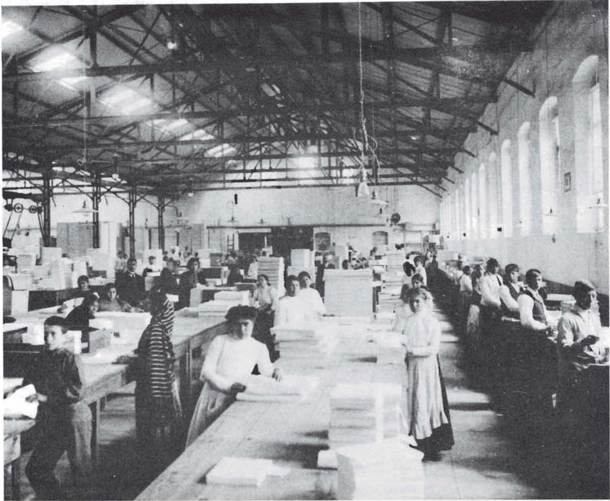
La mano de obra femenina en el departamento de escogido se caracterizaba por la habilidad manual para seleccionar el papel, localizando desperfectos e irregularidades en las resmas.
